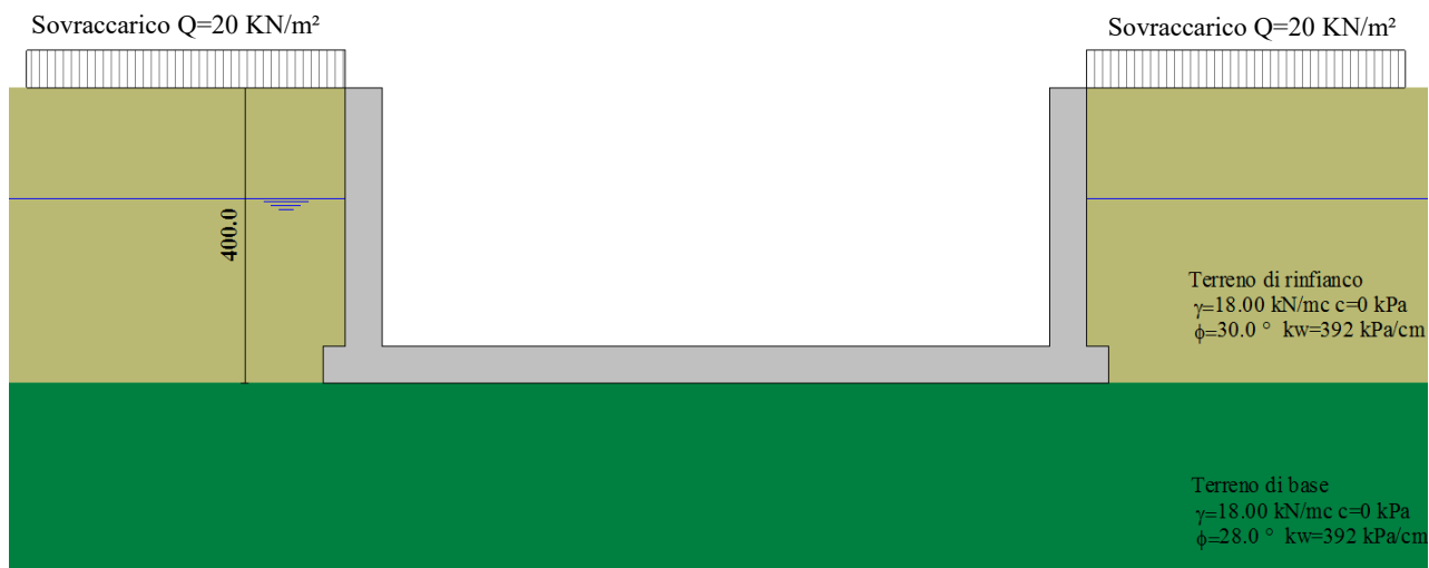
Figura 6.12 - Modello geotecnico e strutturale, sezione tipo della soglia di regolazione
