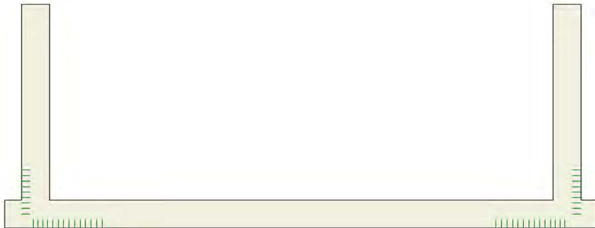
Figura 6.63 – diagramma di involuppo della struttura fessurata, sezione tipo della soglia di regolazione
