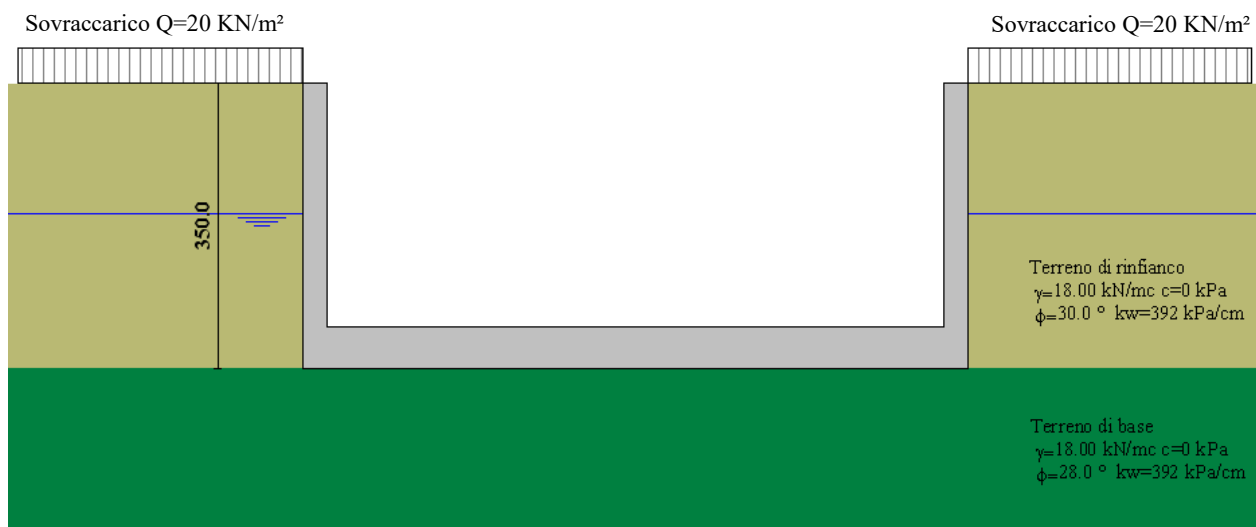
Figura 6.11 - Modello geotecnico e strutturale, sezione dell'opera di scarico
