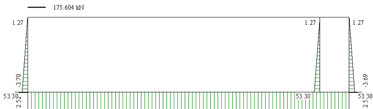
Figura 6.19 – Diagramma di involucro dello sforzo normale, sezione longitudinale di maggior altezza dell'opera di derivazione
